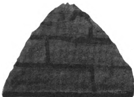
Fig. 54. Kalksandsteine. Zerstörte Mauerwerkskörper in Zementmörtel.
